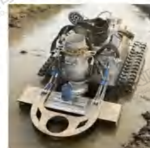
水下50米316L不锈钢清淤机器人 Underwater 50-meter 316L Stainless Steel Dredging Robot
